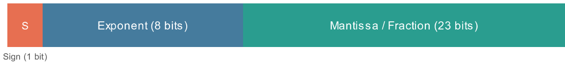
चित्र 9.1 — IEEE 754 single precision format में कुल 32 bits होते हैं: 1 bit Sign, 8 bits Exponent और 23 bits Mantissa (fractional part)।
